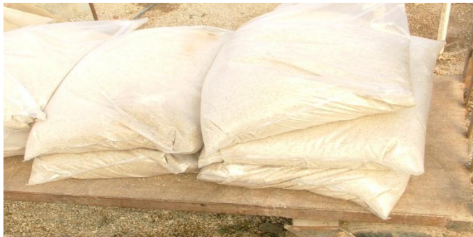
Fotografía n° 46. Arena 1 mm playa lavada.
