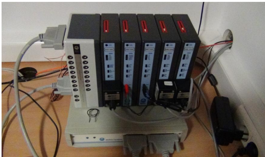
Figura 28: Polígrafo utilizado para el registro de las variables psicofisiológicas.
