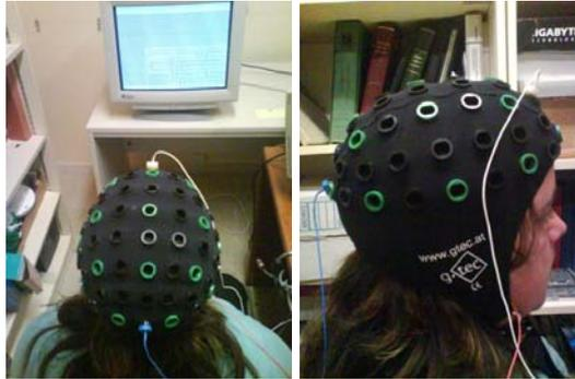
*Figura 6.3 Posicionamiento de electrodos en el BCI-DEPRACAP. Posicionamiento de electrodos. Un único canal diferencial con electrodo activo situado en Oz (en azul), el de referencia en Fz (blanco) y GND en lóbulo derecho (rojo).*
