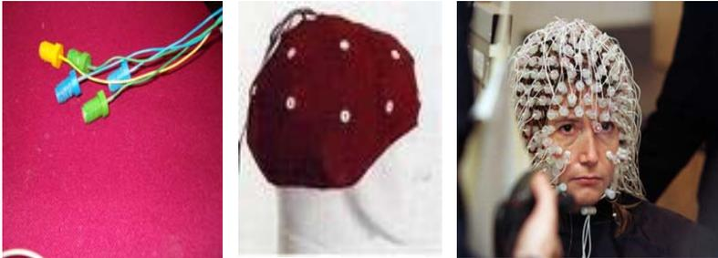
*Figura 19 Sistemas de sujeción de electrodos EEG. De izquierda a derecha. Electrodo usado en un gorro EEG con agujeros y rosca, el Electrocap y el SensorNet de EGI*
