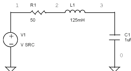
Figura 7.26 – Circuito de test para el análisis transitorio.
