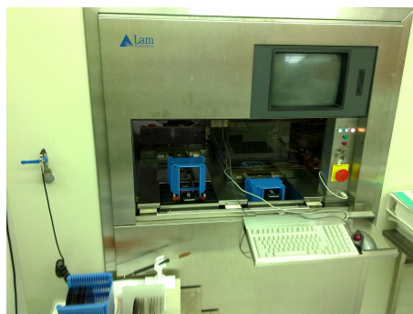
Figura 7.16 – Sistema de ataque por plasma de reacción química de Research Rainbow .
