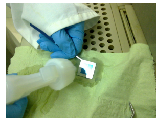
(d) Eliminación de restos líquidos mediante aire comprimido.
