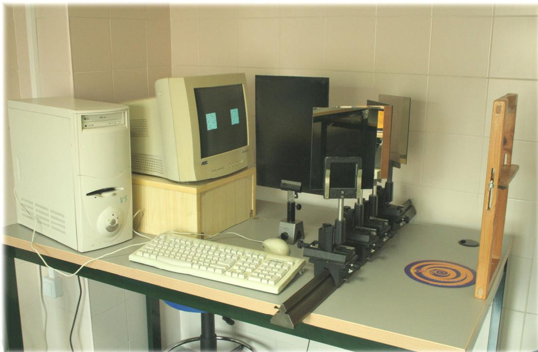
**Figura 3.3.** Fotografía del dispositivo experimental para la medida de la disparidad máxima. Se puede apreciar en el monitor el RDS.
