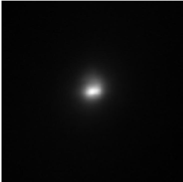
*Figura 2.5. Ejemplo de una imagen de doble-paso para un ojo sano y una pupila de 5 mm.*
