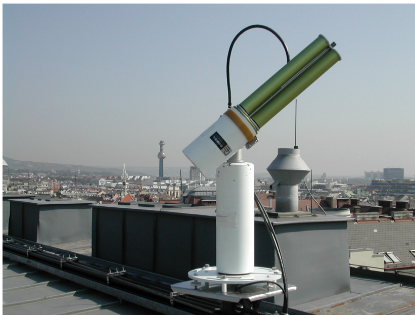
Figura 3.24. Fotómetro solar Cimel CE318-4 (Cortesía de LAA&co).
