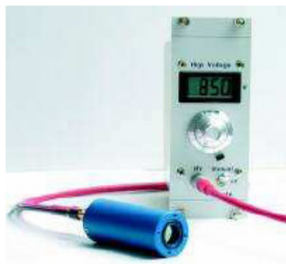
Figura 3.7. Tubo fotomultiplicador del sistema de detección del instrumento Lidar Raman.
