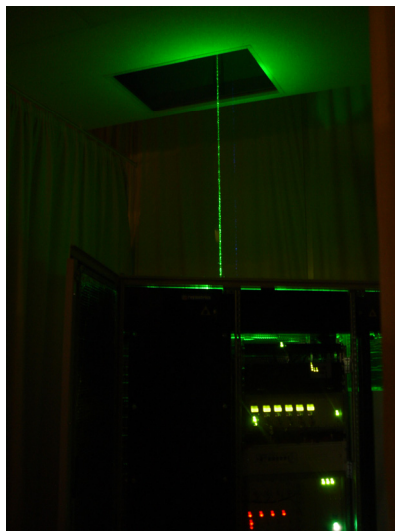
Figura 3.21. Configuración del laboratorio en el que está instalado el sistema Lidar Raman. Las paredes de la ventana del techo reflejan suficiente luz láser difusa.
