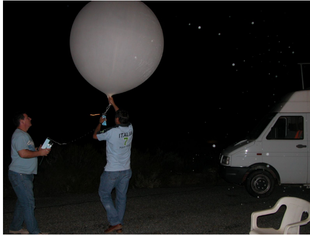
Figura 8.5. Lanzamiento un sistema de sondeo termodinámico.
