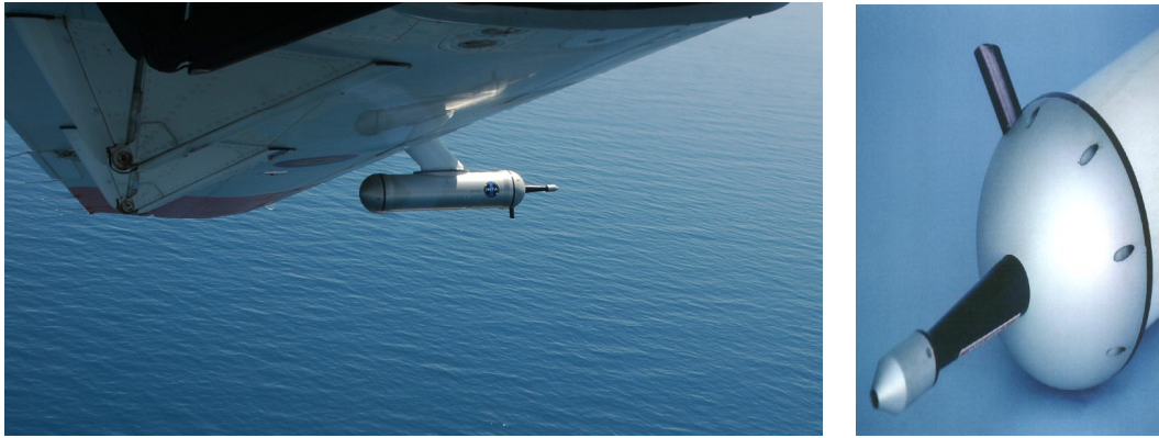
Figura 8.4. Sonda PCASP incorporada en el avión Aviocar C-212. Izquierda, sonda PCASP sobre el ala del avión; derecha, detalle de la sonda PCASP.
