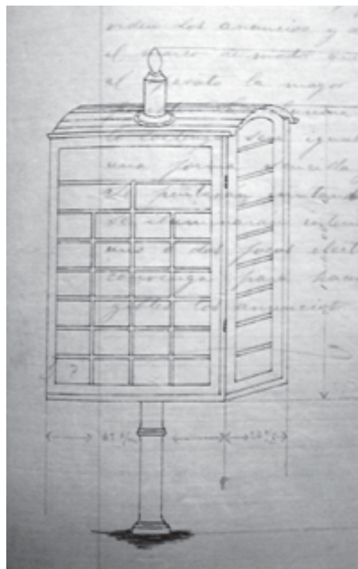
SopORTE para anuncios poligonal con iluminación por retroproyección, dibujo a tinta sobre papel cebolla, 1892.
