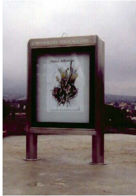
Construcción y prueba de un prototipo de una mampara publicitaria en acero inoxidable, Veracruz, México 1998
