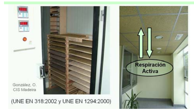
Figura 6: Estudio del comportamiento frente a cambios de humedad.
