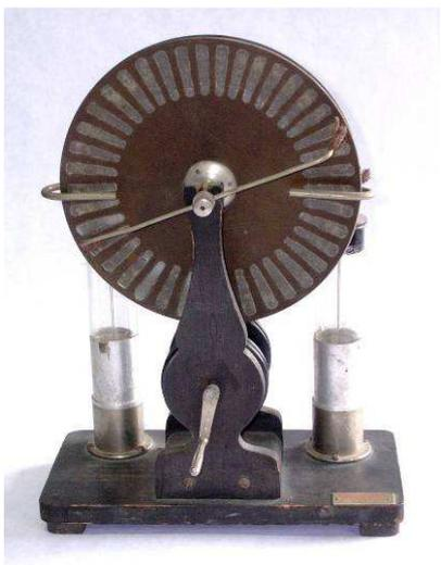
*Fig. 5.5. Máquina eléctrica de Wimshurst* como “de demostración”), aportan los requisitos indispensables para desencadenar los fenómenos que quieren estudiarse, cuya causa primera es el agente. Por ejemplo, la pila de Volta, suministrando corriente, permite el estudio del fenómeno de interacción entre corrientes.
