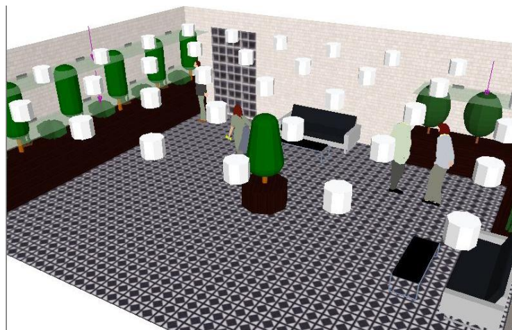
Figura 25. Imagen tridimensional virtual de la propuesta ajardinada. Módulos LED adosados en paredes ajardinadas e iluminación ambiental con incandescentes adosadas en techo. Superficies de cálculo vistas como planos a distintas alturas del ajardinamiento
