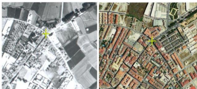
Figura 2-4: Toma de puntos de control para la referenciación de una fotografía aérea. La cruz verde muestra el punto común a la fotografía aérea (1977) de la izquierda y a la ortoimagen (2004) de la derecha. Núcleo urbano de Armilla.
