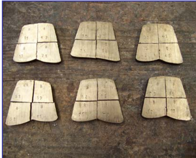
Figura 3.13. Probetas de ensayo tipo B. Partiendo del lingote de la aleación B, éste es seccionado a 1 cm. de grosor, para su posterior fragmentación en cuatro partes y la grabación de su numeración, con el fin de diferenciar cada muestra.
