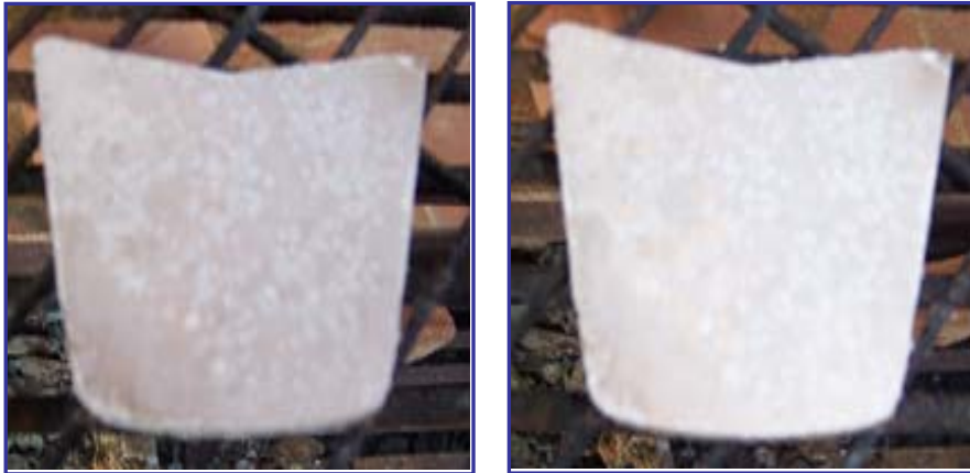
Figura 3.33. Izquierda: probeta de ensayo (H14) de bronce de aleación tipo H, con pátina blanca de ácido bórico en saturación al 30%. Derecha: probeta de ensayo (H15) de bronce de aleación tipo H, con pátina blanca, de ácido bórico en mezcla al 30%.
