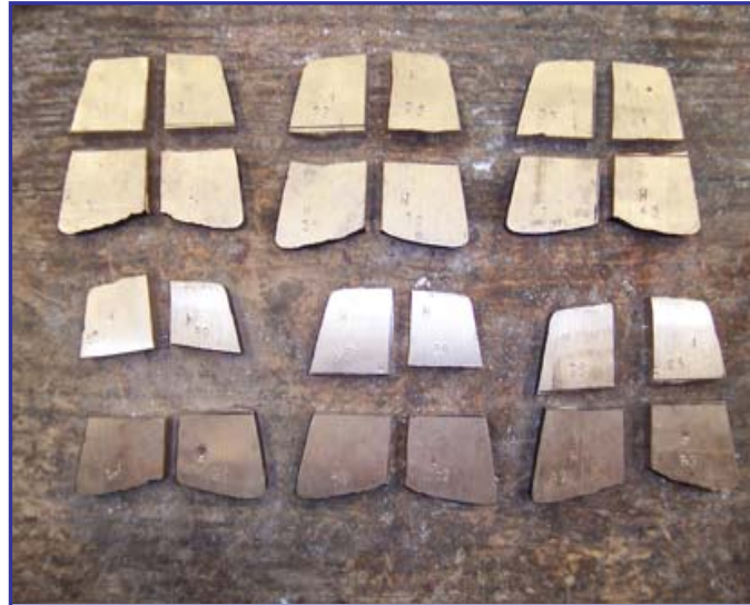
Figura 3.21. Probetas de ensayo tipo H. Partiendo del lingote de la aleación H, éste es seccionado a 1 cm. de grosor, para su posterior fragmentación en cuatro partes y la grabación de su numeración, con el fin de diferenciar cada muestra.
