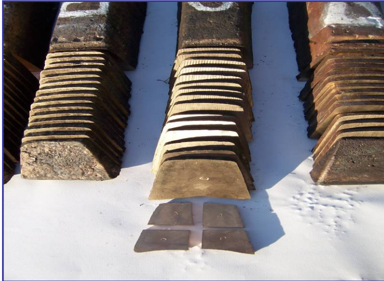
Figura 2.13. Proceso de la elaboración de las probetas de ensayo, partiendo de los lingotes de las seis aleaciones seleccionadas (A, B, C, D, E y H), seccionados a 0,85cm., para su posterior fragmentación en cuatro partes.
