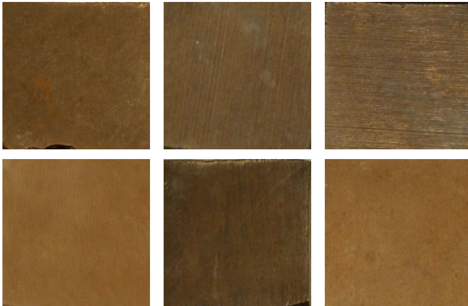
Figura 6-8. Pátinas naturales obtenidas a la intemperie en un año, sobre bronce de las aleaciones tipo A, B, C, D, E y H.
