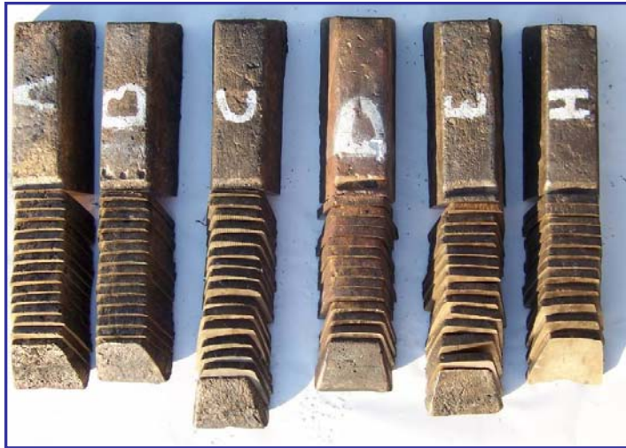
Figura 2.9. Cortes transversales de los diferentes lingotes de bronce
