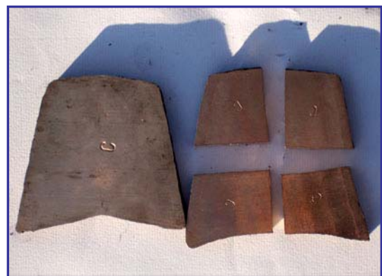
Figura 2.7. Proceso de corte de las secciones en cuatro partes
