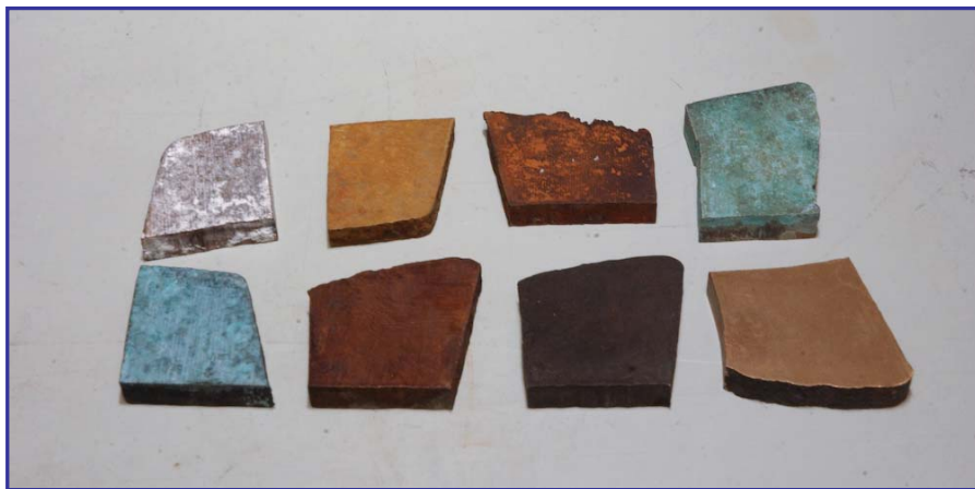
Figura 3.23. Color de las probetas de ensayo tratadas con las siete pátinas artificiales más la natural a la intemperie.
