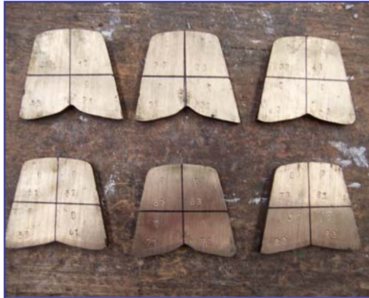
Figura 3.17. Probetas de ensayo tipo D. Partiendo del lingote de la aleación D, éste es seccionado a 1 cm. de grosor, para su posterior fragmentación en cuatro partes y la grabación de su numeración, con el fin de diferenciar cada muestra.
