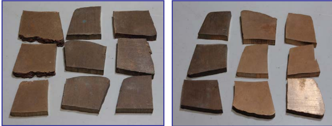
Figuras 2.40 y 2.41. De izquierda a derecha: Aleaciones A, B, C, D, E y H tras un año a la intemperie.
