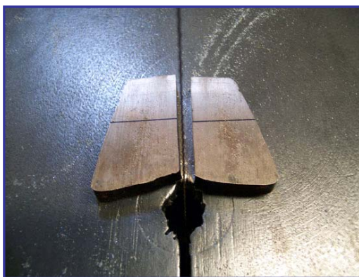
Figura 2.7. Proceso de corte de las secciones en cuatro partes
