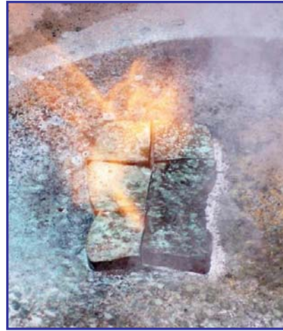
Figuras 2.18 y 2.19. Aplicación de calor y químico sobre las probetas de ensayo (izquierda). Ennegrecimiento de las probetas de ensayo al quemarse (derecha).
