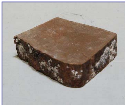
Figura 3.100. Muestra de pátina blanca en la cual, tras un año ha perdido prácticamente los cristales que interactuaban con el metal.
