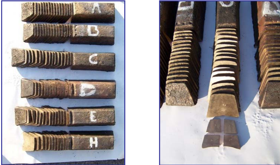
Figura 3.9 La aleaciones de bronce en los lingotes y proceso de fragmentado. Arriba, lingotes de bronce en su color natural, en todos los tipos de aleaciones (A, B, C, D, E y H). Abajo, proceso desde el lingote hasta las probetas de ensayo.
