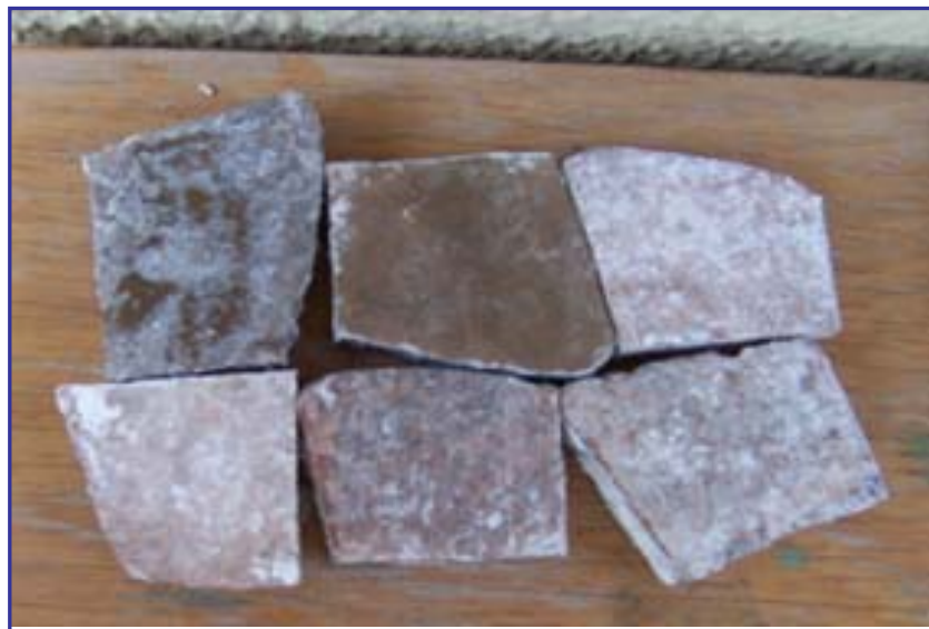
Figura 3.25. Probetas de ensayo de bronce con pátina blanca sobre todos los tipos de aleaciones (A, B, C, D, E y H)
