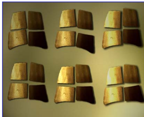
Figura 3.15. Probetas de ensayo tipo C. Partiendo del lingote de la aleación C, éste es seccionado a 1 cm. de grosor, para su posterior fragmentación en cuatro partes y la grabación de su numeración, con el fin de diferenciar cada muestra.
