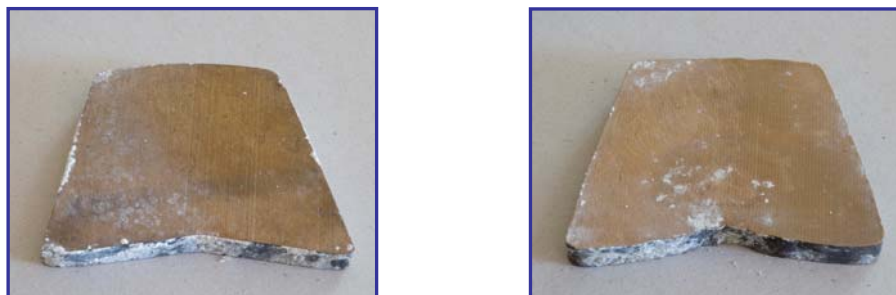
Figuras 2.26 y 2.27. Pátina blanca sobre superficie texturada H14 (izquierda) pasado un año. Pátina blanca sobre superficie texturada H15 (derecha).
