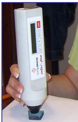
Figura 3.6. Colorímetro “DR LANGE colorpen, con los que se han realizado las mediciones colorimétricas CIELAB 1976 de los valores medios del color de las probetas de ensayo de bronce natural y patinadas.
