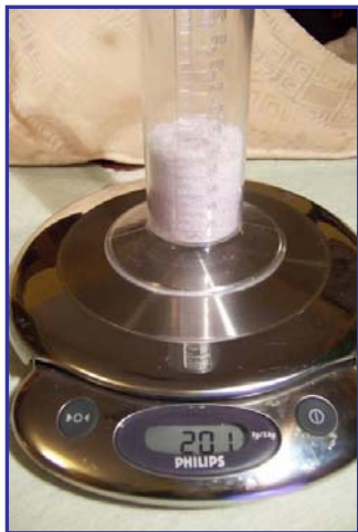
Figuras 2.14 y 2.15. Medición de la cantidad de químico para su disolución (izquierda). Limpieza de las muestras (derecha).
