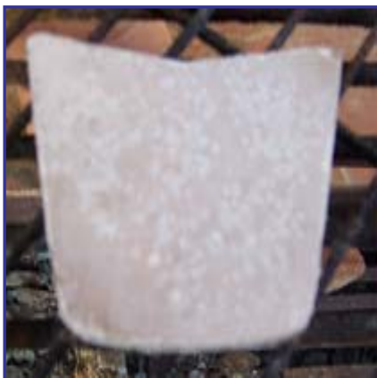
Figuras 2.24 y 2.25. Pátina blanca sobre superficie texturada H14 (izquierda). Pátina blanca sobre superficie texturada H15 (derecha).
