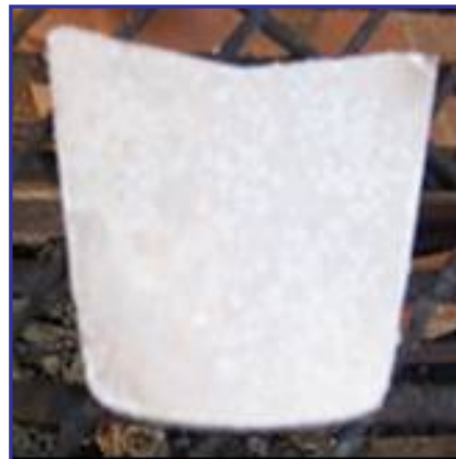
Figuras 2.24 y 2.25. Pátina blanca sobre superficie texturada H14 (izquierda). Pátina blanca sobre superficie texturada H15 (derecha).
