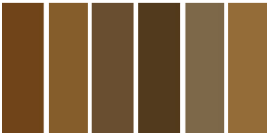
Figura 6-9. Valores medios de las mediciones CIELAB, de las pátinas naturales obtenidas a la intemperie en un año, sobre bronce de las aleaciones tipo A, B, C, D, E y H
