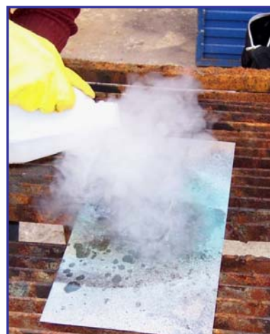
Figuras 2.20 y 2.21. Enfriamiento de las probetas de ensayo con agua destilada
