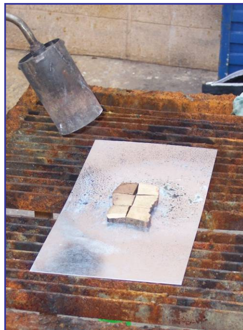
Figuras 2.16 y 2.17. Antorcha de boca ancha alimentada por gas butano (izquierda). Aplicación de calor a las probetas de ensayo mediante la antorcha (derecha)
