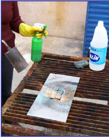
Figuras 2.18 y 2.19. Aplicación de calor y químico sobre las probetas de ensayo (izquierda). Ennegrecimiento de las probetas de ensayo al quemarse (derecha).
