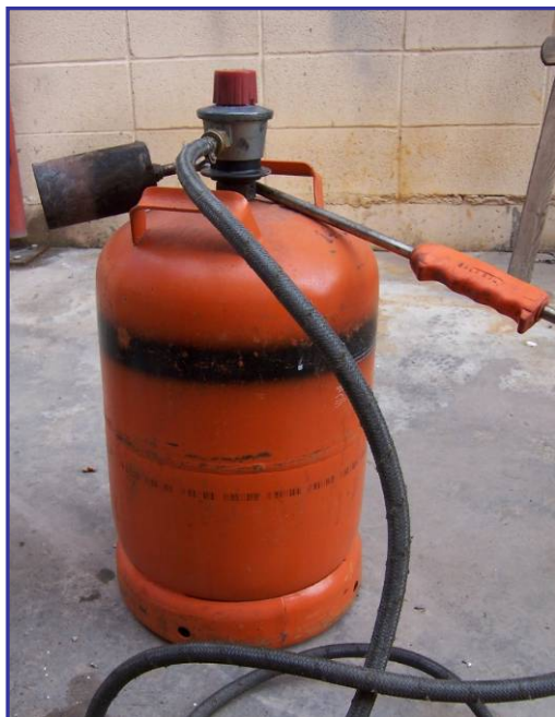
Figuras 2.16 y 2.17. Antorcha de boca ancha alimentada por gas butano (izquierda). Aplicación de calor a las probetas de ensayo mediante la antorcha (derecha)
