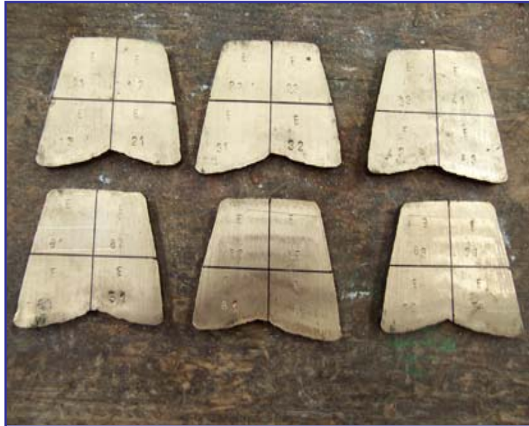
Figura 3.19. Probetas de ensayo tipo E. Partiendo del lingote de la aleación E, éste es seccionado a 1 cm. de grosor, para su posterior fragmentación en cuatro partes y la grabación de su numeración, con el fin de diferenciar cada muestra.
