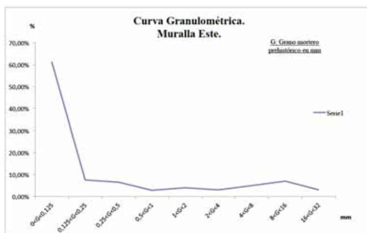
Fig. 3.68. Curva granulométrica de morteros de la Muralla Este. Fortín V.
