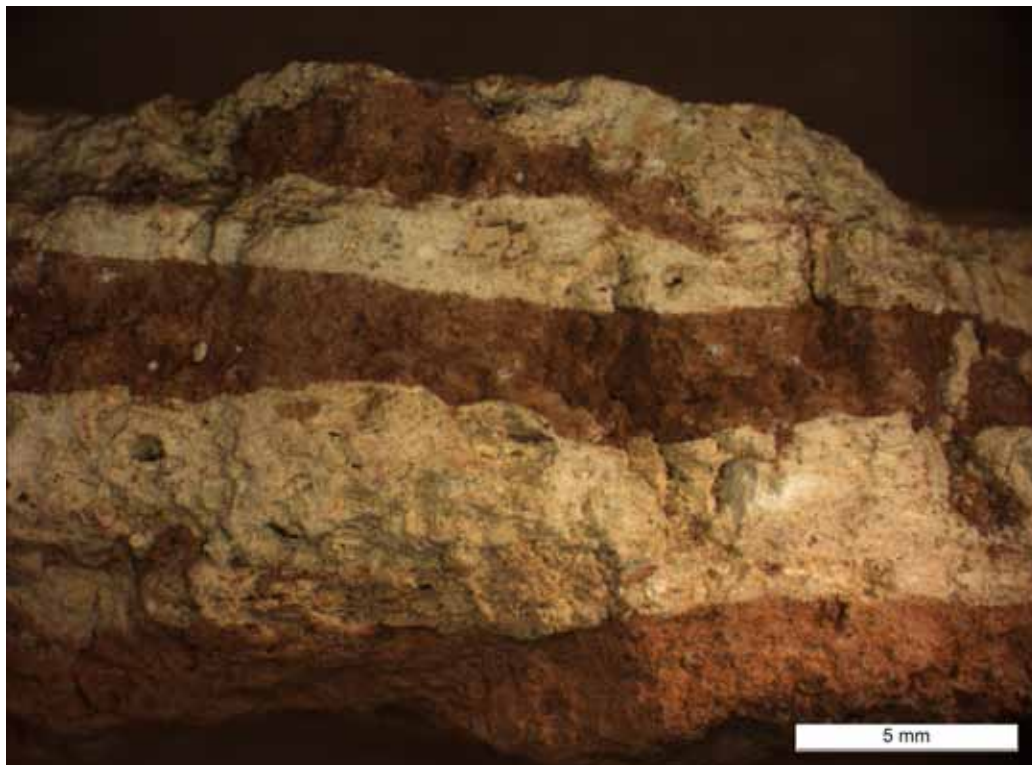
Foto 5.20. Imagen de microscopio que muestra alternancia de revocos y enlucidos D-161750.
