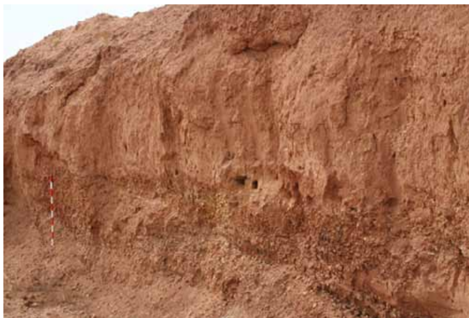
Foto 5.23. Perfil geológico de canteras de arcilla que muestra el horizonte ay b de suelos.
