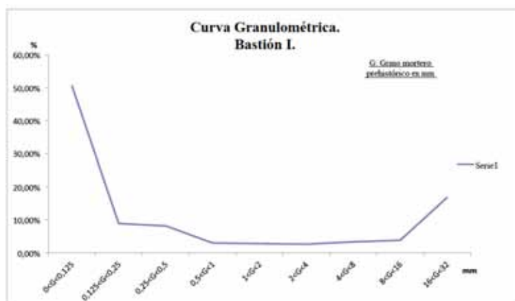
Fig. 3.66. Curva granulométrica de morteros del Bastión I. Fortín V.
