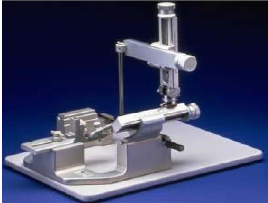
**Figura 2:** El aparato estereotáxico adaptado a los roedores
