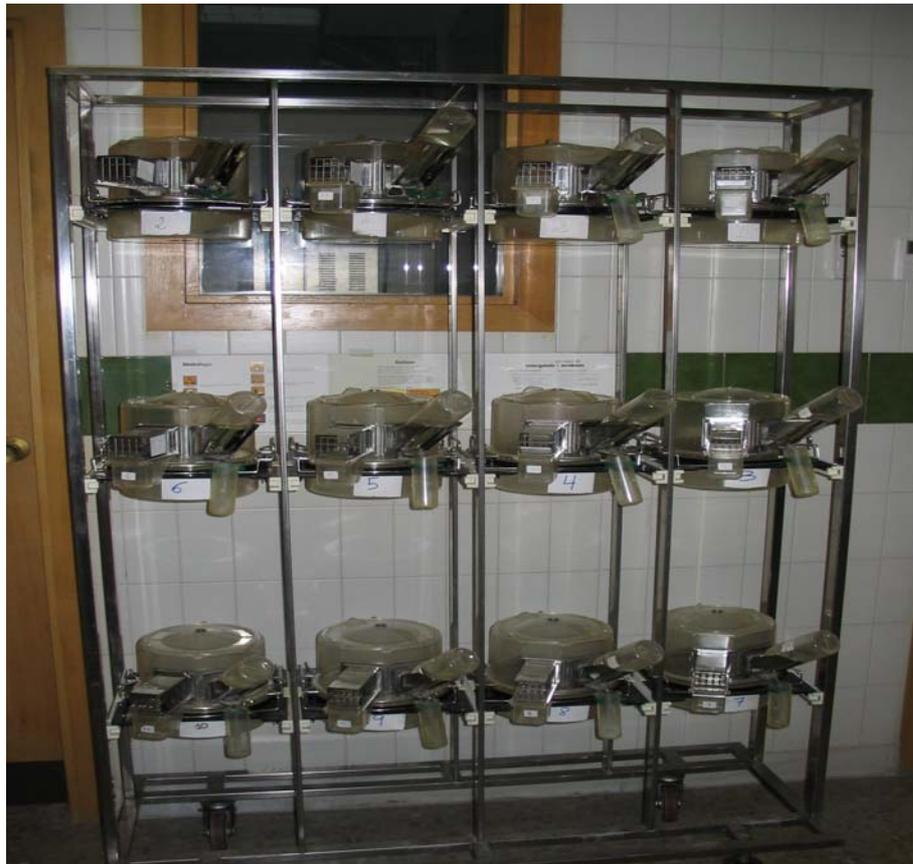
**Figura 1:** Jaulas individuales de metabolismo diseñadas para el control de la ingesta y de la bebida
