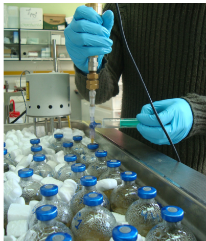
Figura 3.2. Medida de la presión y del volumen de gas en los frascos Wheaton.
