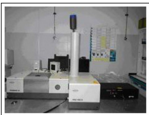
Figura 18 - Módulo FT-RAMAN, BRUKER FRA 10
