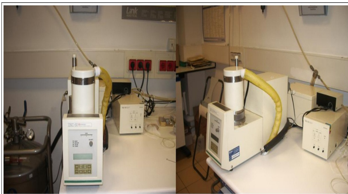
Figura 22 – Calorímetro Diferencial de Barrido (DSC)
