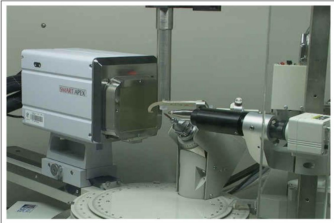
Figura 19 - Equipo de difracción de monocristal con detector de área.(Bruker Smart Apex, Alemania) usado para microanálisis en diferentes puntos del diente
