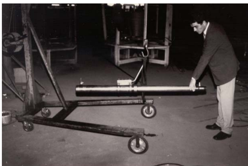
Figura 4.10. Gato empleado en armadura pretesa para tesar un solo cordón.
