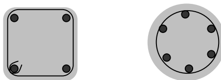
Figura 9.1. Secciones de pilares, cuadrada y circular
