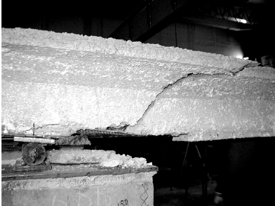
Agotamiento por cortante. Cortesía del Instituto Eduardo Torroja. CSIC
