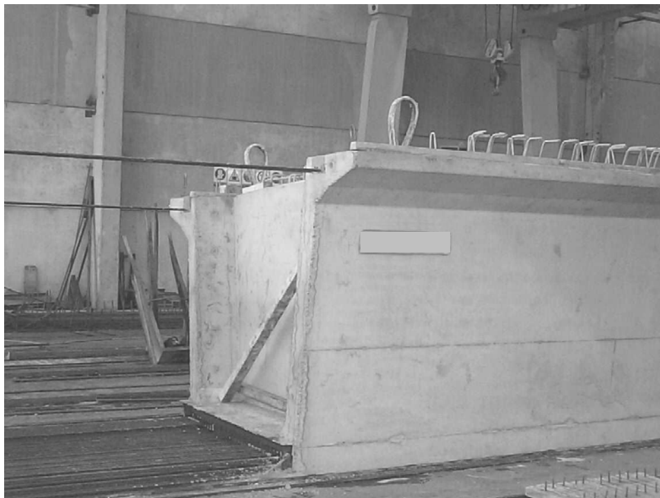
Viga pretensada tipo artesana, antes de destesar.
