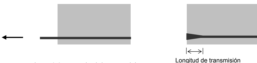
Figura 3.27. Longitud de transmisión
