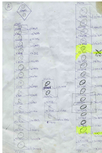
341.-1ª escultura. Esquema de los radios de subdivisión del 1º caso de deformación (en color los 3 radios elevados pertenecientes al área a deformar), y medidas ordenadas de uno de los 16 tránsitos de radio a radio. La escultura se compone de un total de 1008 piezas.
