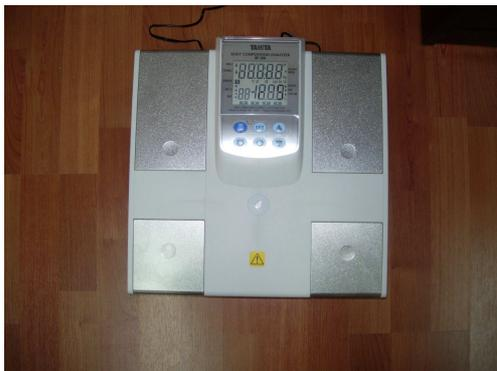
*Figure 3.13. Bioimpedanciómetro.*
