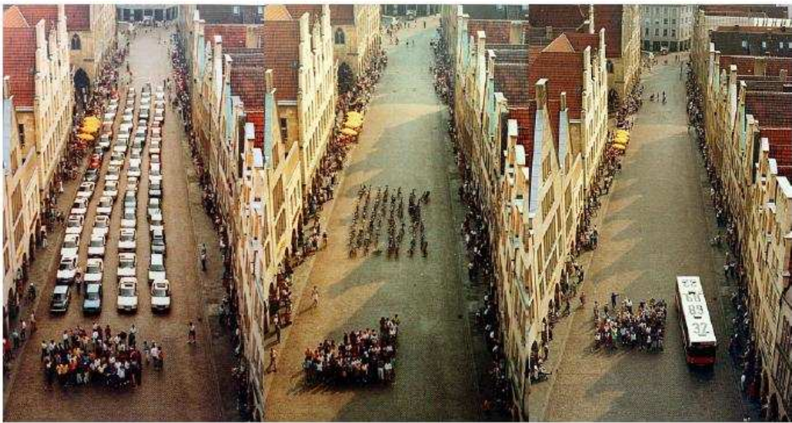
FIG. 17. La fotografía corresponde a un experimento realizado por el departamento de planificación urbana de la ciudad alemana de Münster en 2001 con el que se pretendía mostrar el espacio físico para mover al mismo número de personas según tres tipos de transporte: coche, autobús y bicicleta. Ello ayudó a concienciar a la ciudadanía y a los dirigentes sobre la necesidad de incrementar el uso del transporte público y en especial el no motorizado. Los resultados del experimento fueron concluyentes: para transportar 72 personas se requerían 90 m 2 de espacio en bicicleta (una persona por bicicleta), 30 m 2 de espacio en autobús (suponiendo un autobús con capacidad suficiente para transportar a este número de personas) y 1000 m 2 para el transporte en automóvil (suponiendo 60 automóviles para desplazar a las 72 personas).
