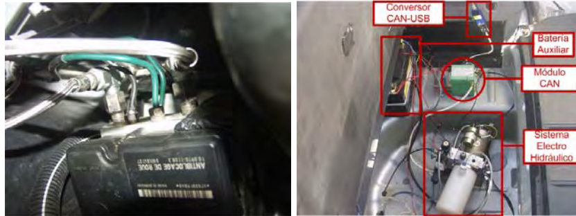
Figura 3.3: Válvula selectora entre sistema manual-automático (izquierda). Sistema de frenado electro hidráulico situado en el hueco de la rueda de repuesto del vehículo (derecha).
