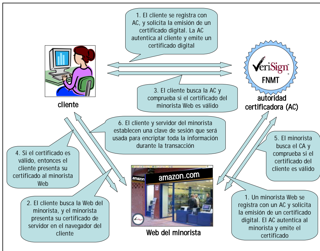
Figura 53: Funcionamiento completo de un certificado digital
