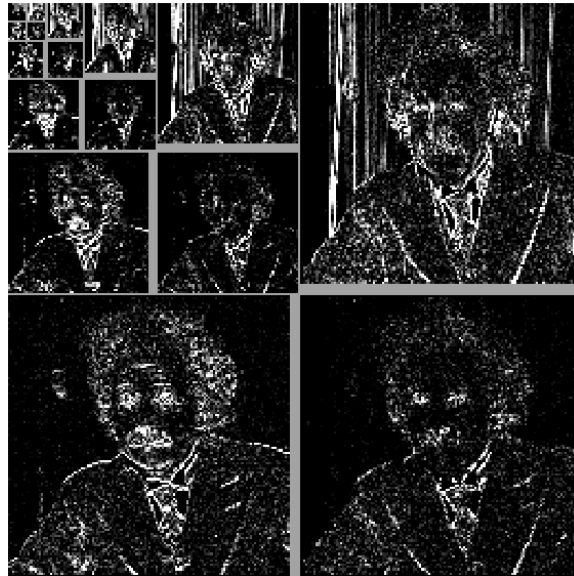
Figura 2.7. Coeficientes en amplitud de la transformación wavelet (Haar) de la imagen de Einstein 256 \times 256 .
