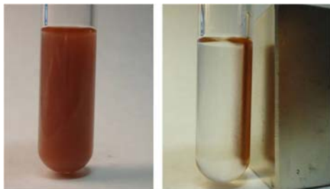
Figura 6.13. Separación del catalizador mediante un campo magnético externo
