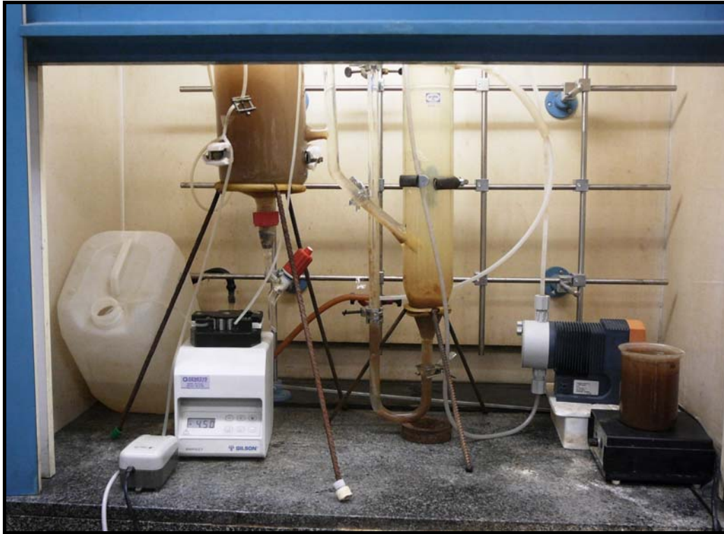
Figura IV.15. Reactor biológico de lodos activados, usado en este estudio.
