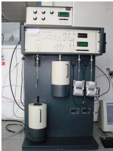
Figura II.4. Equipo Autosorb empleado para la obtención de las isothermas de adsorción.
