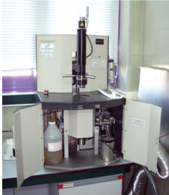
Figura II.5. Porosímetro de mercurio utilizado.
