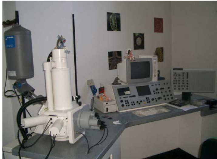
Figura II.6. Microscopio electrónico de barrido utilizado.
