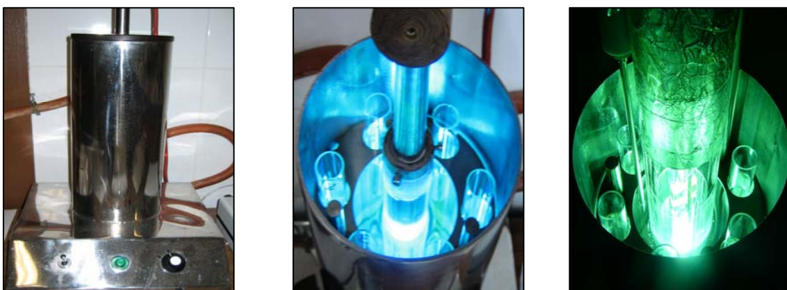
Figura V.3. Imágenes del fotorreactor utilizado para los experimentos de irradiación UV.
