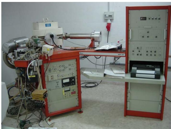
**Fig. 3.6.** Espectrómetro de masas de doble ingreso MAT-251.
