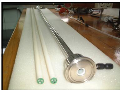
Figura 5.3. Módulo de membrana y carcasa utilizados.
