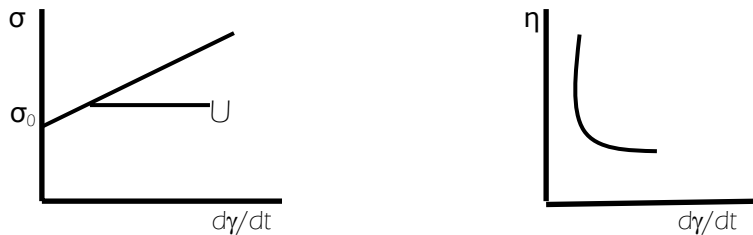
Figura 8. Reograma de plástico ideal: Se observa la disminución de viscosidad con el aumento de la velocidad de deformación.
