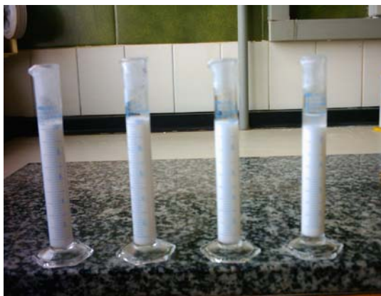
Figura 19. Ensayo de sedimentación. Método de la probeta.
