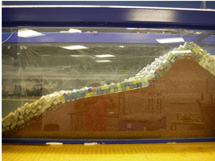
**Figura 4.38:** Sección del modelo de dique en S con núcleo impermeable.
