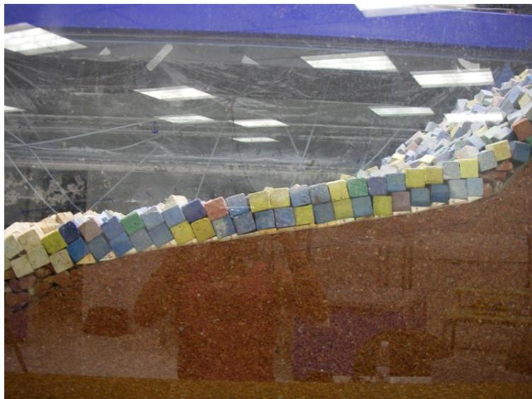
**Figura 4.39:** Talud intermedio del modelo de dique en S con núcleo impermeable.
