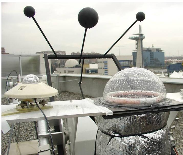
Figura 4.2. Sistema de adquisición de imágenes del cielo basado en cámara RGB.
