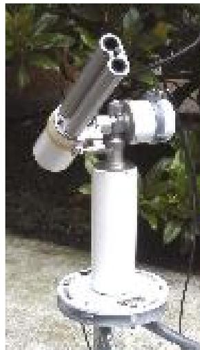
Figura 4.14. Espectrofotómetro CIMEL CE318.
