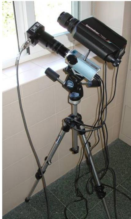
Figura 5.3. Disposición del espectrorradiómetro y la cámara con el LCTF en el trípode.
