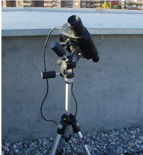
Figura 4.5. Espectrorradiómetro PR650 realizando las medidas espectrales de entrenamiento y de test.
