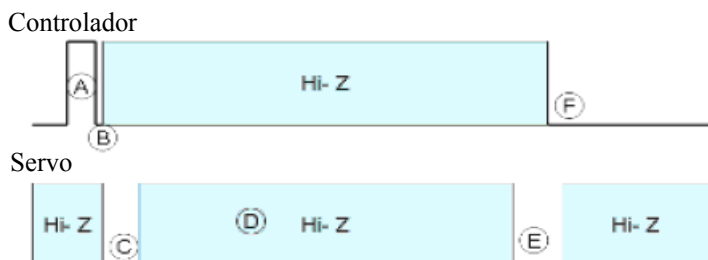
Ilustración 45: Señal de control del protocolo HMI para la medida de la posición del eje de giro del servo HSR-8498HB. (A) El controlador genera un pulso de 50 microsegundos. (B) Controlador mantiene la señal de 2 a 20 microsegundos y pasa a alta impedancia. (C) El servo reconoce el pulso y continúa poniendo la señal en baja durante 125 microsegundos. (D) El servo envía la posición manteniendo la señal en alta entre 250 y 2550 microsegundos en función de la posición. (E) El servo pone la señal en baja durante 250 microsegundos. (F) El controlador reconoce el final de la secuencia y coloca la señal en baja.
