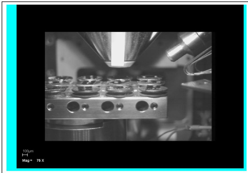
**Figura 3.** Interior del microscopio electrónico de alta resolución con los tambores que contienen una muestra del anverso y otra del reverso de cada una de las obras seleccionadas. C.I.C, U.G.R.
