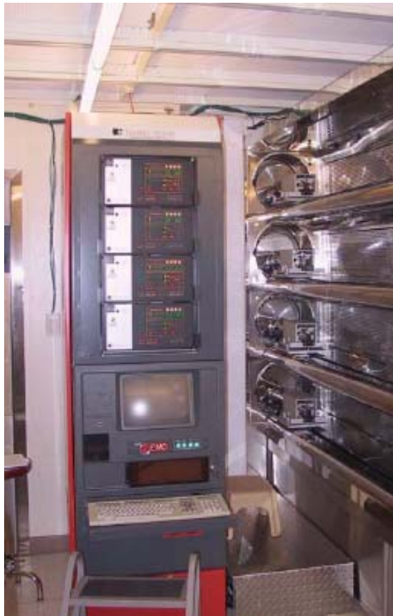
Figura 10.2.5. Horno de difusión con el módulo de control a la izquierda y cuatro reactores de difusión.
