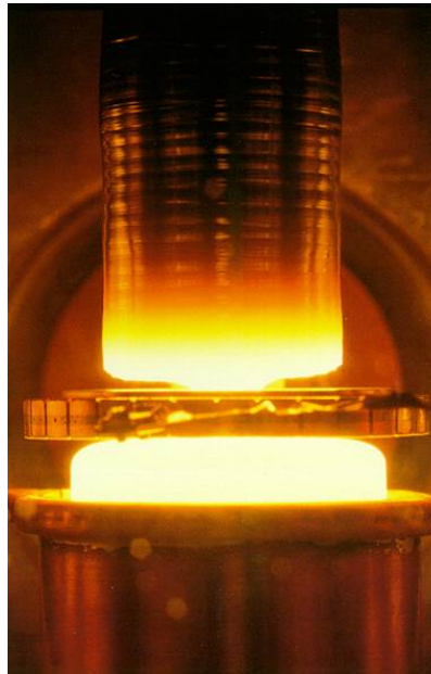
Figura 9.2.5: Método de zona flotante http://www.oja-services.nl/iea-pvps/ar02/dnk.htm
