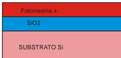
(b) Recubrimiento con una resina fotorresistente positiva
