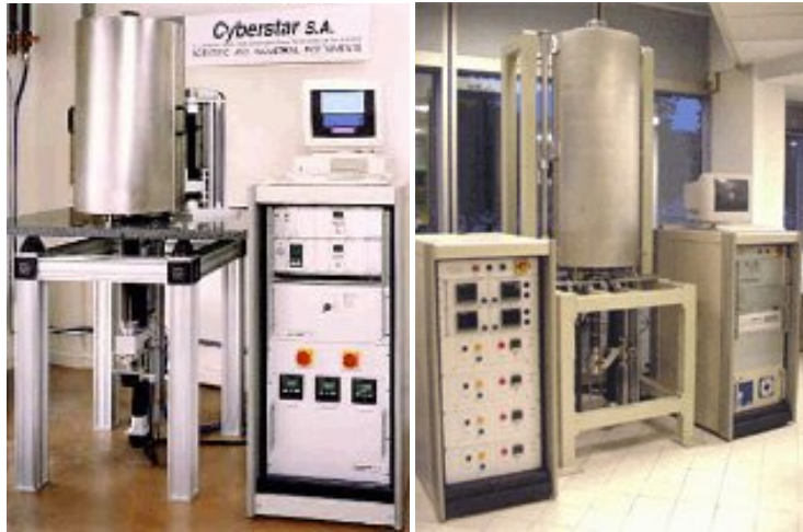
Figura 9.3.4: Horno vertical de Bridgman de tres zonas (izquierda) : Horno vertical de Bridgman de cuatro zonas industrial (derecha) http://www.cyberstar.fr/crystal/bridgman.htm
