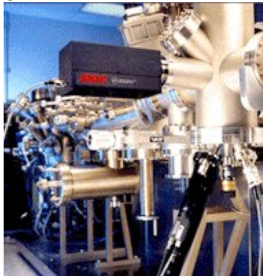
Figura 14.1.21: Sensor Óptico Multihaz montado en un sistema de deposición de película delgada comercial.
