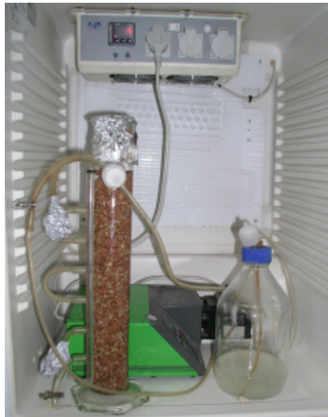
Fig. 10.- Filtro sumergido a escala de laboratorio durante la inoculación
