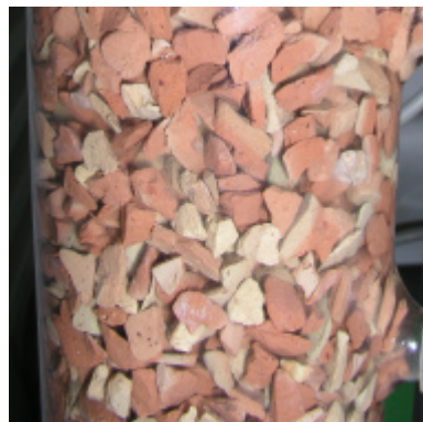
Figura 7 Aspecto del material soporte usado en el filtro sumergido.
