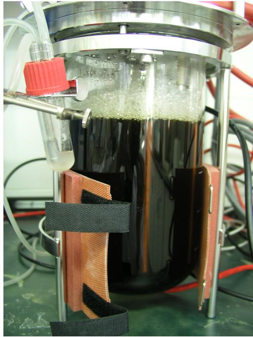
**Figura 4.41.** Biorreactor con inóculo selectivo de *Azotobacter chroococcum* H23 en alpeorujó diluido al 60% digerido anaerómicamente (300RPM)
