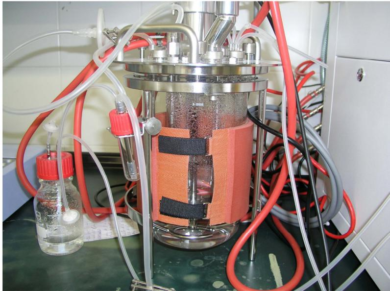
**Figura 3.5.** Fotografía del reactor Biostat®- plus con diversos sensores
