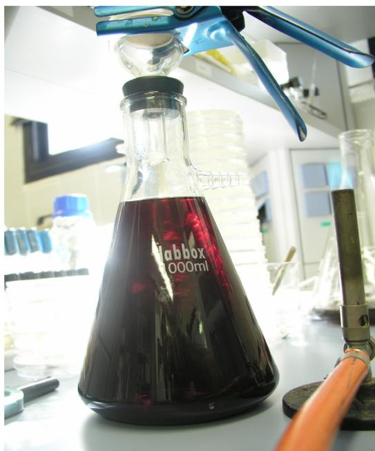
**Figura 4.40.** Esterilización por filtración del sustrato de alpeorujo digerido anaerobicamente
