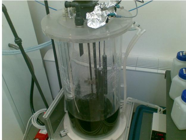
**Figura 3.6.** Fotografía del reactor de 30 L de capacidad con diversos sensores
