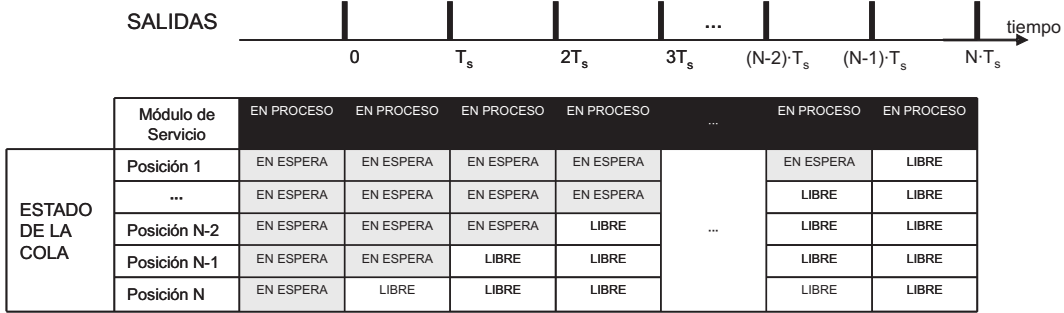
Fig. 2.5: Servidor monoproceso: diagrama de los tiempos entre salidas consecutivas y estado del procesamiento de varias peticiones cuando el tiempo de servicio es constante.
