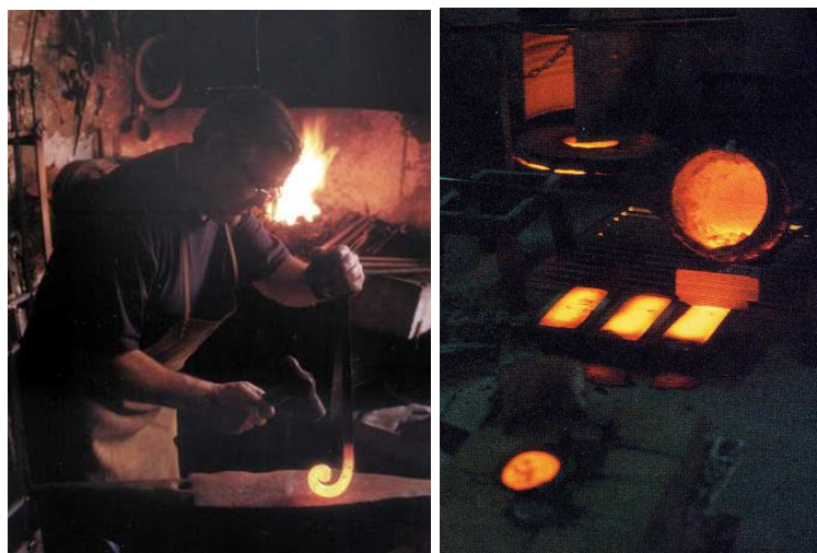
Imagen 111 y 112. El trabajo en un taller de fragua y proceso de fundición de sus piezas para el museo MAPFRE. (Foto de Nuria Urbano.)
