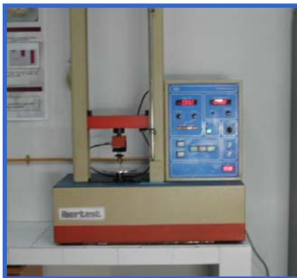
Figura 17. Máquina de ensayo Electrotest 500.
