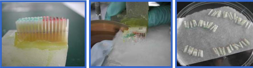
Figuras 12-14. Obtención de las barras de un milímetro cuadrado de sección.
