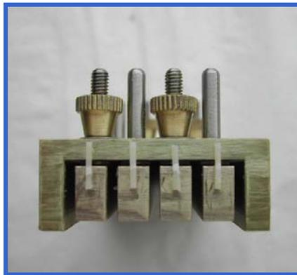
Figura 16. Montaje de las barras en la probeta de microtensión.
