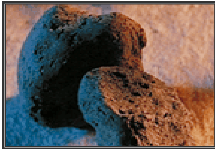
Figura 6.1.- Detalle de material de relleno: arcilla FILTRALITE.
