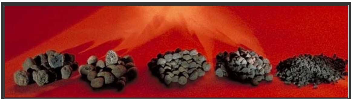
Figura 6.2.- Detalle de diferentes tipos arcilla expandida FILTRALITE.
