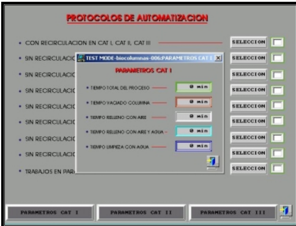
Figura 5.6.- Detalle del Scada: Protocolos de Automatización.
