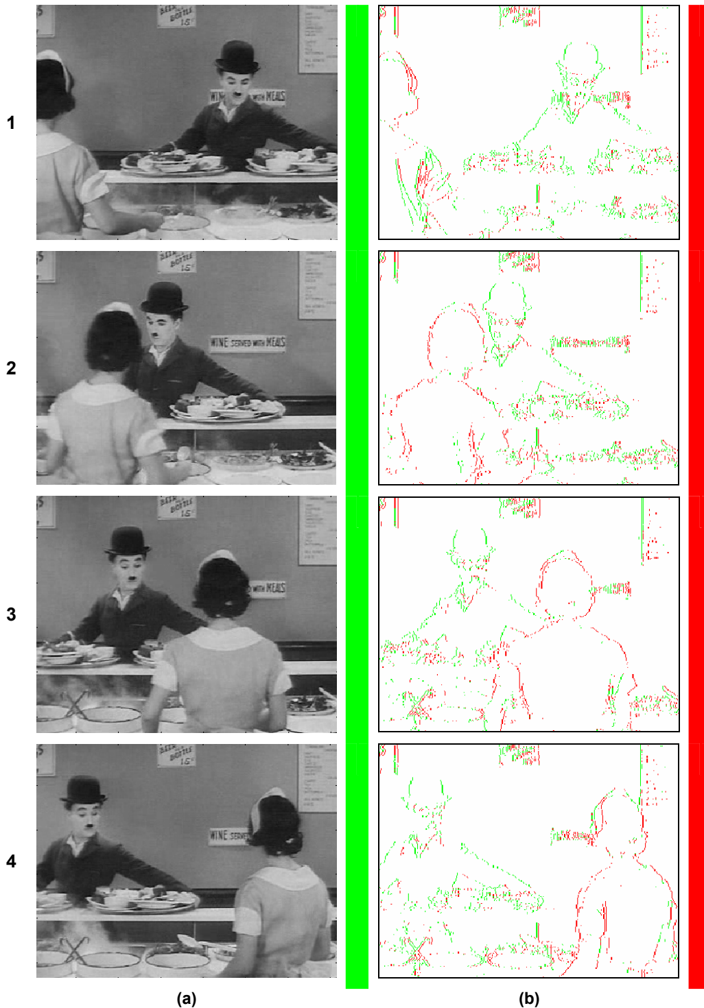
Figura 2.12. Extracción del movimiento mediante el algoritmo de correlación de Reichardt: (a) Imagen original procesada; (b) Características en movimiento.
