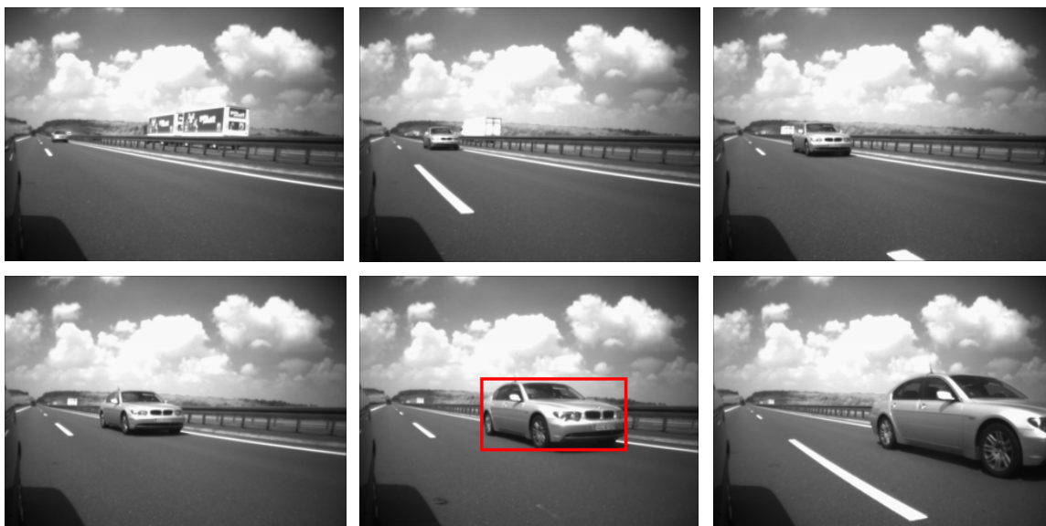
Figura 5.3. Selección de algunas imágenes correspondientes a una de las secuencias que vamos a utilizar para realizar el estudio del rango de velocidades detectadas por el algoritmo.
