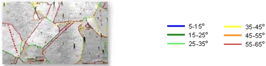
Figura 21. Mapa de bordes de grano. El color de la línea indica el ángulo que forman dos puntos contiguos.
