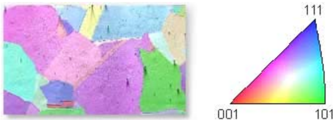
Figura 20. Figura de polo inversa. El color en cada punto de la imagen representa la orientación de los ejes cristalográficos
