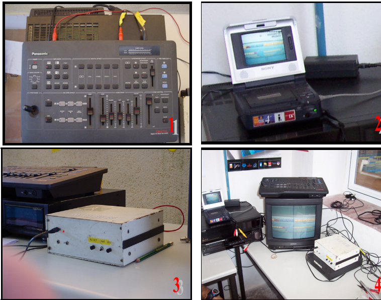
Figura 2.9: Vista colocación del material utilizado. 1) Mezcladora; 2) Mini DV; 3) Video Cronómetro; 4) Vista general selector- video cronómetro- mezcladora- monitor- mini DV.
