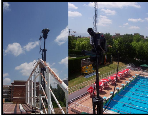
Figura 2.16: Imagen de la colocación y orientación de la cámara 1 utilizada para la filmación de la salida y referencia en 5 m y 10 m.
