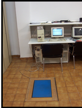
Figura 2.1: Disposición de la Plataforma de Fuerza Dinascan/IBV encastrada en el suelo del laboratorio.
