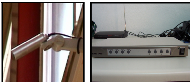
Figura 2.13: Imagen de la disposición del sistema de cámaras auxiliares colocadas en la pared para la filmación de seguridad y del generador de cuadrantes utilizado.
