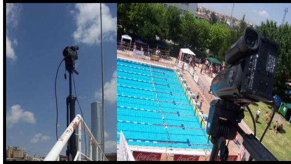
Figura 2.19: Imagen de la colocación y orientación de la cámara 4 utilizada para la filmación de la referencia de 40 m y 45 m.
