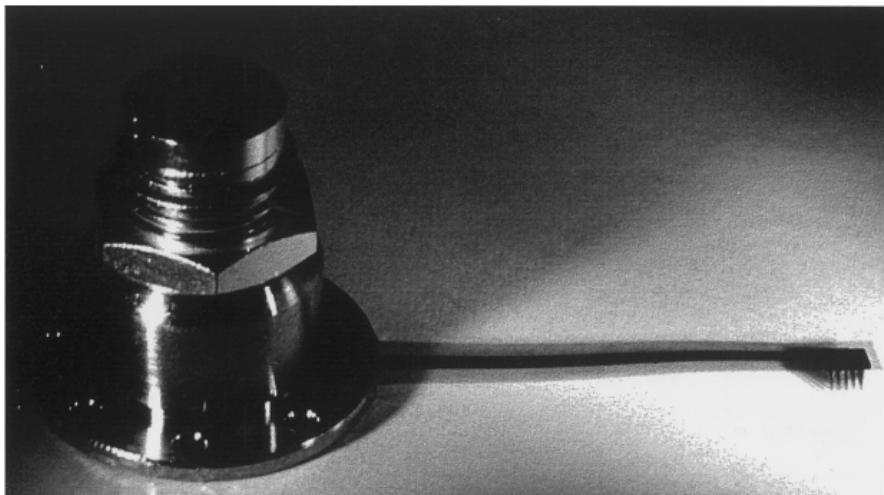
Figura 3.4: Matriz de electrodos de Utah, dotada de cinta de conexión, y conjunto de pedestal más terminal transcutáneo para su fijación al cráneo. [NORM99]
