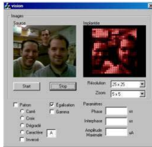
Figura 2.8: Ejemplo de interfaz gráfica de usuario para un implante visual cortical (PolyStim) [COUL05]
