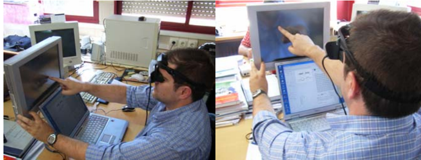
Figura 4.5: Uso de la plataforma V1 Cortistim para la tarea del mapping de fosfenos, en modo de simulación. El sujeto voluntario observa fosfenos cuya posición se genera aleatoriamente, a través de las gafas de realidad virtual. Ubica el fosfeno tocando la pantalla táctil con la mano derecha, mientras que usa la izquierda para tomar referencia de la posición de la misma.
