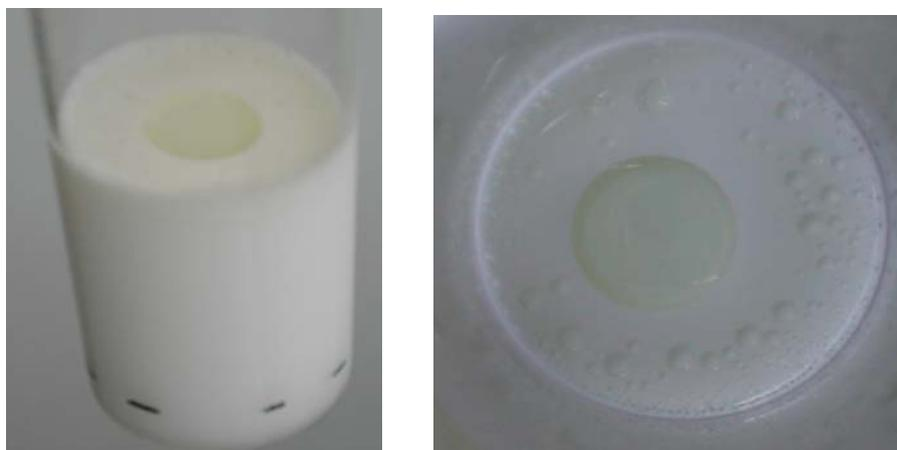
**Figura IV.12:** Fotografía de una emulsión con 5 % de trioleína y 0.2 g/L de Glucopon 650 (3000 minutos tras la preparación). Se aprecia el cremado por efecto de la coalescencia.
