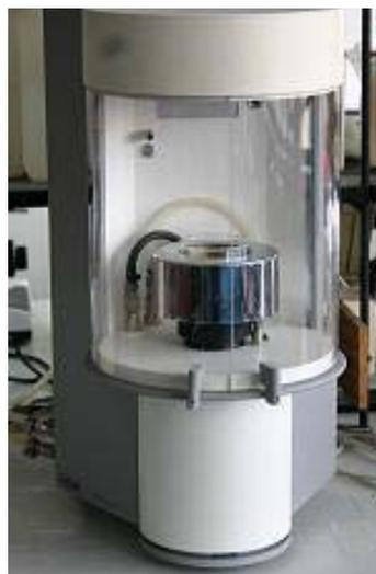
**Fig.14** : Tensiómetro modelo K-11 de KRÜSS.
