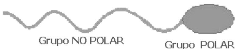
**Figura I.1:** Estructura básica de un tensioactivo
