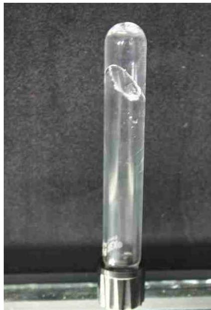
**Figura IV.69:** Fotografía a 25 °C de una muestra del sistema Findet 1214N/23-Agua con un 34 % de tensioactivo que contiene cristal líquido cúbico.
