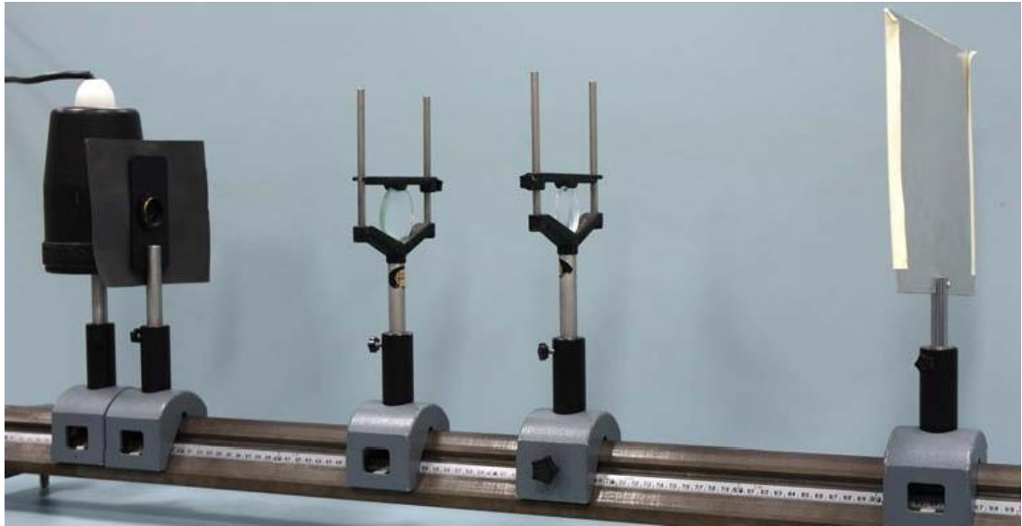
Figura 3.5. Montaje experimental para la medida de la focal de una lente divergente mediante el método de Gauss.
