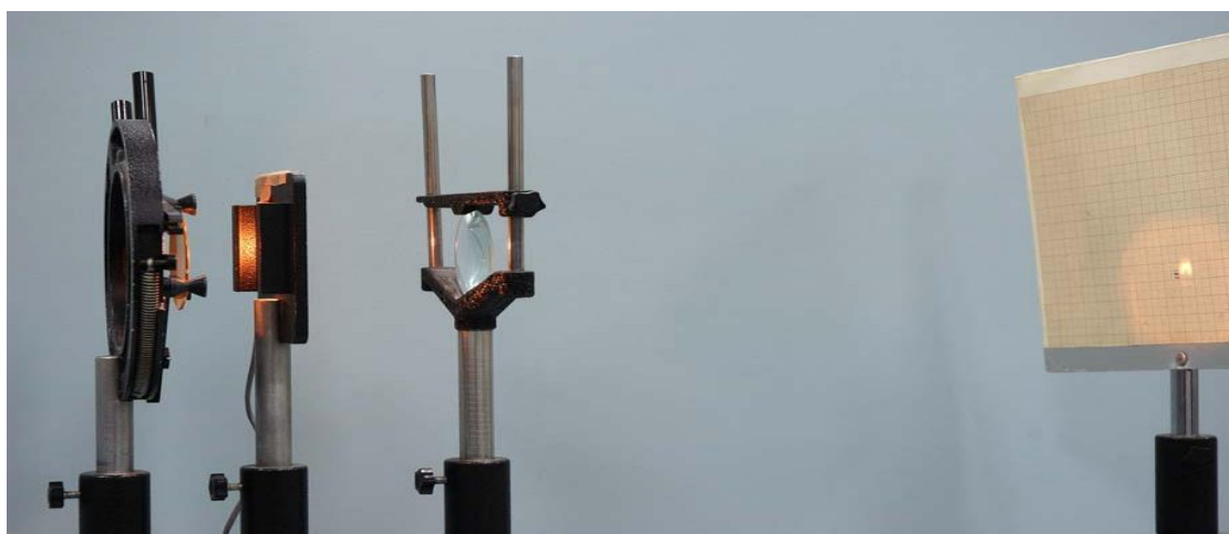
Figura 5.5. Dispositivo experimental para la medida del radio de un espejo convexo.
