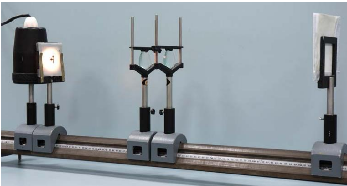
Figura 6.1. Montaje para hallar los planos antiprincipales del sistema compuesto.
