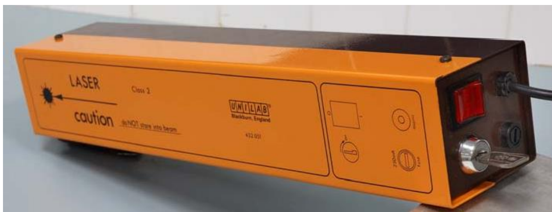
Figura A1.11. Láser de He-Ne.
