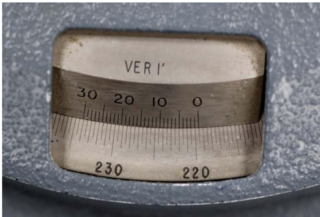
Figura 7.4. Detalle del nonius del espectrogoniómetro.
