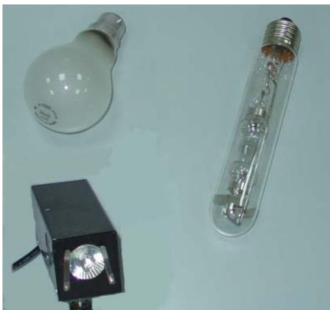
Figura A1.7. Tipos de lámparas.
