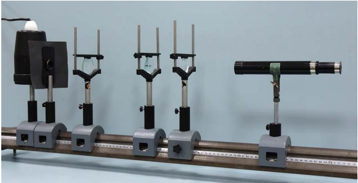
Figura 3.4. Montaje experimental para la medida de la focal de una lente divergente mediante el método de Galileo.
