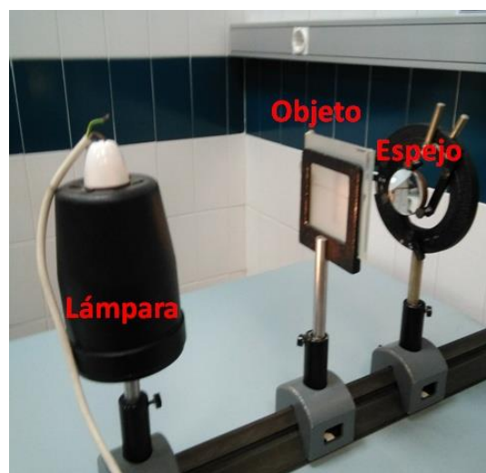
Fig. 5.3. Dispositivo experimental para la medida del radio de curvatura de un espejo cóncavo
