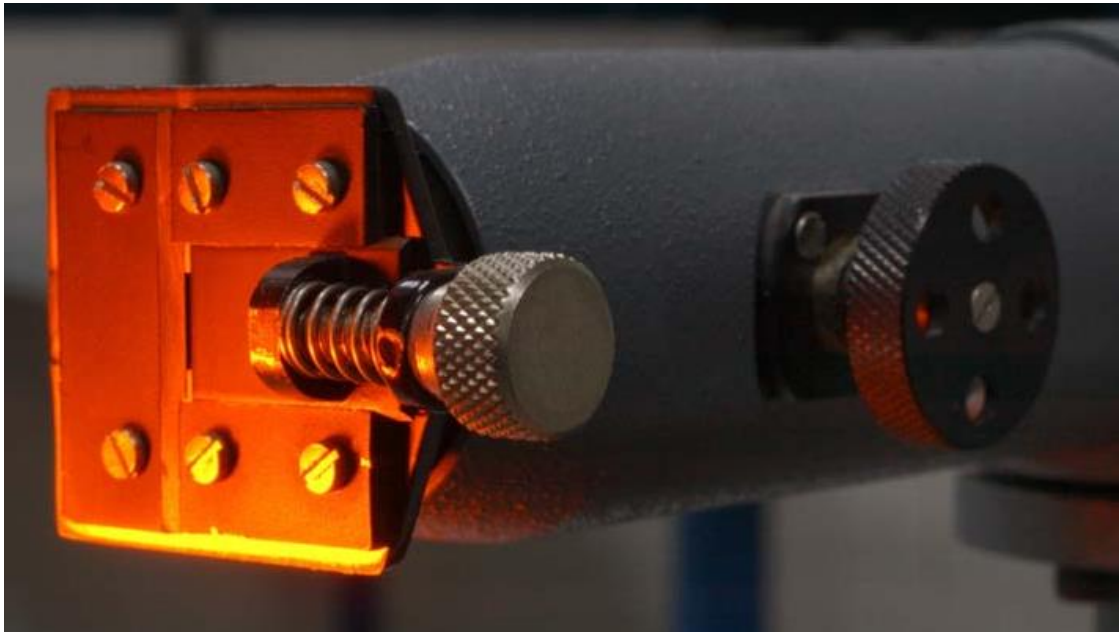
Figura A2.3. Detalle de la rendija y tornillo del colimador de un espectrogoniómetro.
