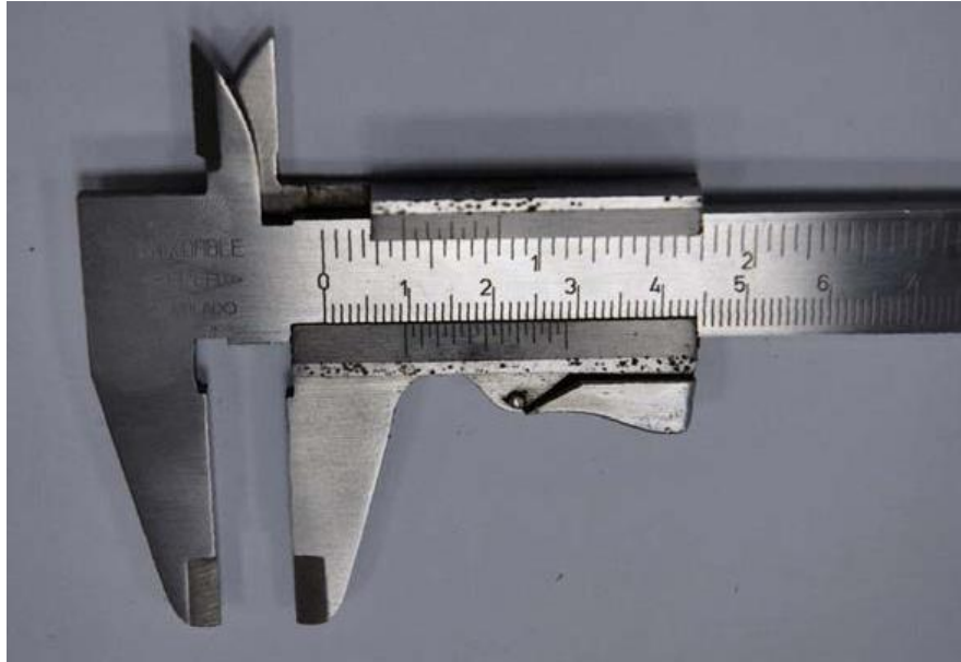
Figura 2.7. Calibre, utilizado en la práctica para medir el espesor de las láminas planoparalelas.
