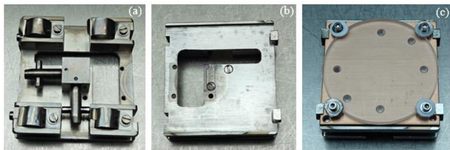
Figura 3.11: Carrillo porta-muestras utilizado para el transporte de la muestra hasta el reflectómetro (a) Vista trasera, con el sistema de sujeción de los manipuladores de doble bayoneta, (b) Vista frontal sin muestra, (c) Vista frontal con muestra.
