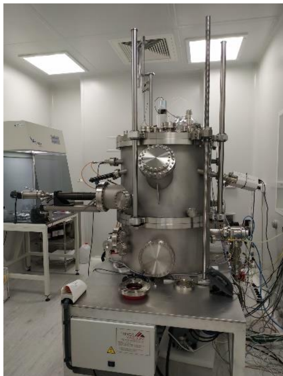
Figura 3.8: Cámara de deposición de láminas delgadas Big-Bell que opera en condiciones de UHV.
