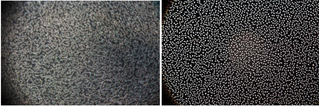
Figura 5.3: Imágenes con el microscopio óptico de la muestra preparada a 350^\circ\text{C} (a) reflexión en campo oscuro y (b) transmisión en campo oscuro.
