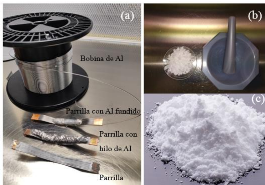
Figura 3.7: Imagen de los materiales utilizados en este trabajo de investigación. (a) Fuente de filamentos de W con Al fundido, (b) \text{AlF}_3 en grano y mortero de ágata, (c) \text{AlF}_3 en polvo fino listo para cargar la fuente.
