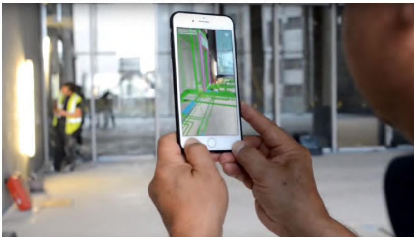
Figura 5. La pantalla del móvil y la realidad aumentada muestra las capas de las instalaciones en el proceso de la construcción. Fuente: GAMMA AR, https://images.adsttc.com .
