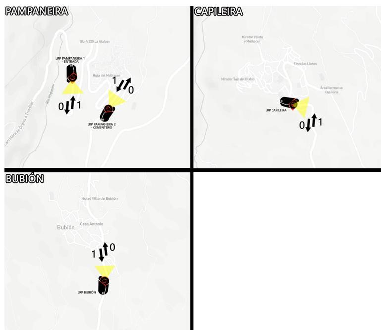
Figura 1.1: Localización de las cámaras de reconocimiento de matrículas con un símbolo de cámara y la codificación que recibe (1 o 0) en función del sentido de la marcha del vehículo, según las flechas.
