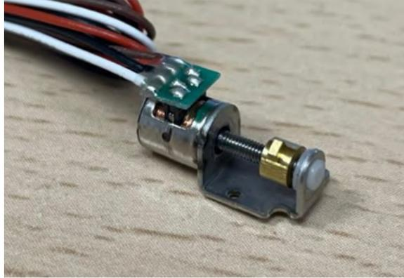
Figura 7.1: Fotografía de micro-motor paso a paso potencialmente adaptable a una RIS.
