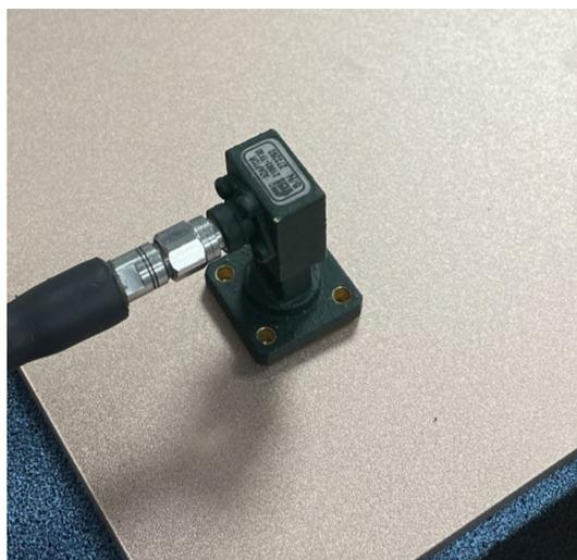
Figura 3.13: *Setup* de medida en guía de onda, donde el plano de salida de la transición de WR34 se coloca paralelo a la placa a medir, en este caso a la placa con metalización en plata y cobre.
