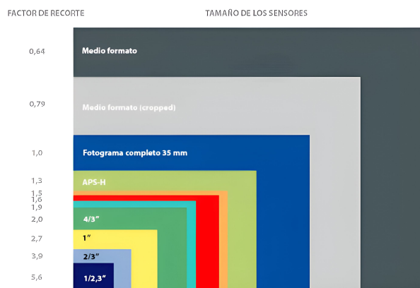
Figura 2.10: Comparación de tamaños de sensores fotográficos expresados según el factor de recorte [57]. Los tamaños van desde medio formato hasta 1/2.3".
